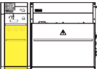
带有黄色标识的功能单元需要采用加长型或超长型手柄才能操作。
